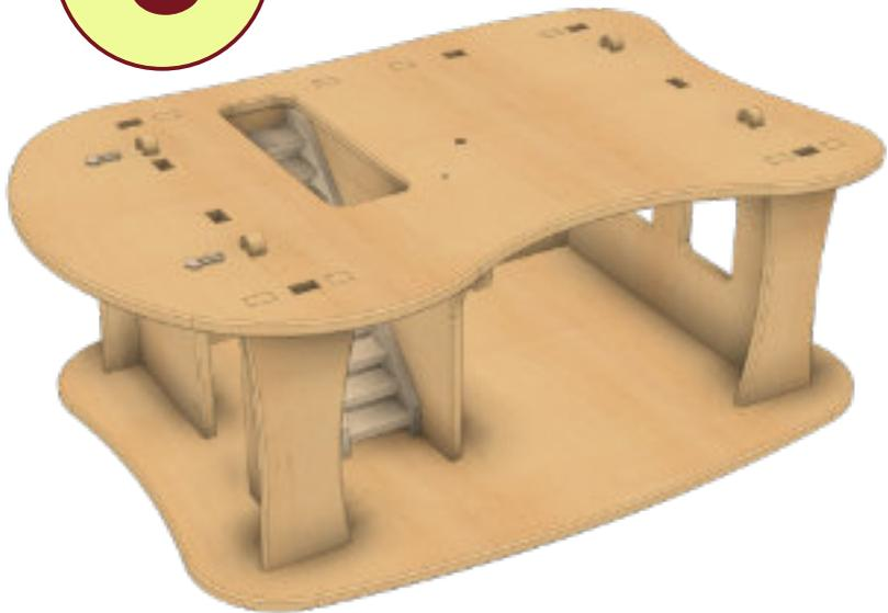
In Schritt 5 werden die Arretierlaschen eingesteckt. Nachdem der Zwischenboden aufgesteckt wurde (Schritt 6), wird die Wendeltreppensäule in diesen eingesteckt. Vorerst kann die Stange bis auf die Grundplatte durchgesteckt werden. Das kleine Querloch muss sich dabei am unteren Ende der Stange befinden. Falls die Stange nur sehr straff in das Loch hineinrutscht, reicht es auch, wenn sie nur ein klein wenig in den Zwischenboden eingeschoben wird. Später wird sie ohnehin wieder nach oben geschoben.
